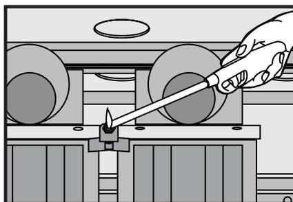
3.- Las válvulas de ajuste del piloto se pueden encontrar en el tubo de alimentación, detrás del panel de control. Se puede acceder a las válvulas a través de orificios en el panel de control. **Hay un piloto por cada dos quemadores.**
