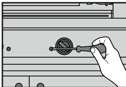
4.- La llama piloto debe ajustarse para proporcionar amplitud de llama de 7/8" (22 mm) a 1" (25 mm) de longitud.
