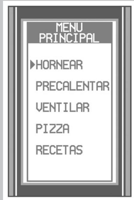
**1.1.- Procedimiento** Para iniciar el horneado debe presionar **ENTER** cuando el cursor esté señalando **HORNEAR**.
