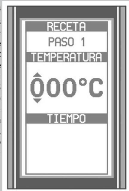
La selección de parámetros del **PASO 2** se lleva a cabo de la misma forma que la selección de parámetros del **PASO 1**. Y una vez seleccionados los del **PASO 2** se deben seleccionar los del **PASO 3**. En caso de que se desee que la receta solo conste del **PASO 1** lo que se debe de hacer es seleccionar una temperatura de 0°C en el **PASO 2**, y, si lo que se quiere es que la receta solo tenga **PASO 1** y **PASO 2** se debe de seleccionar una temperatura de 0°C en el **PASO 3**.
