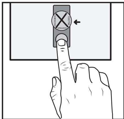
Cuando el piloto ya este prendido, hay que girar la perilla roja hasta el apartado de **ENCENDIDO**, y en ese momento con el termostato puede escoger la temperatura deseada; automáticamente los quemadores se prenderán.
